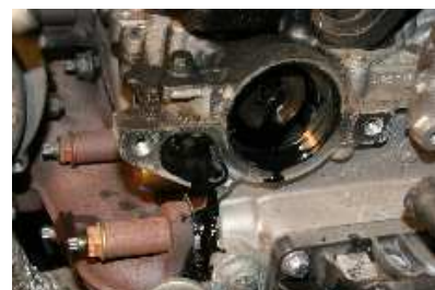
Vervuilde olie uit het oliekanaal vacuümpomp.
