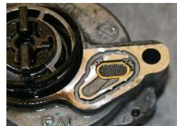
Zeefje in vacuümpomp, geen overmatige vervuiling
