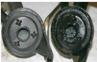
Nieuwe en vervuilde olie aanzuigbuis.
